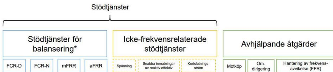
Figur 2 Översikt över Svenska Kraftnäts olika stödtjänster och avhjälpande åtgärder [2] (*samma sak som balanstjänster)
