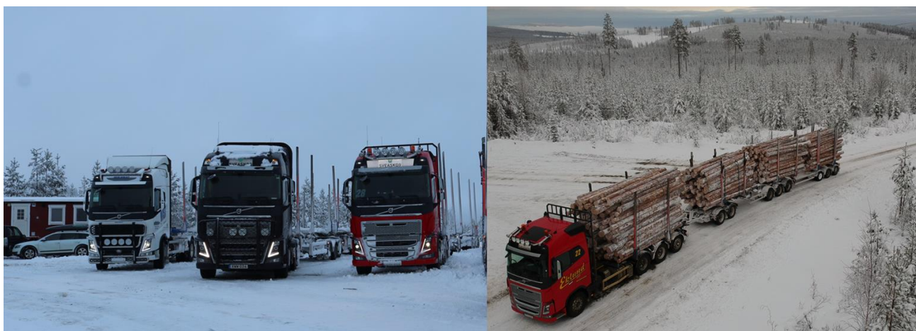
Figur 2. Från vänster till höger: Vit lastbil med fyraxligt släp (64ton). Mörkröd dragbil med link och semitrailer (HCT16b 74 ton). Röd lastbil med femaxligt släp (74 ton). Röd lastbil med dolly link och semi-trailer (98 ton)
